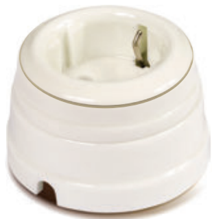
Розетка фарфоровая (16А/250В~) двухполюсная с заземляющим контактом
