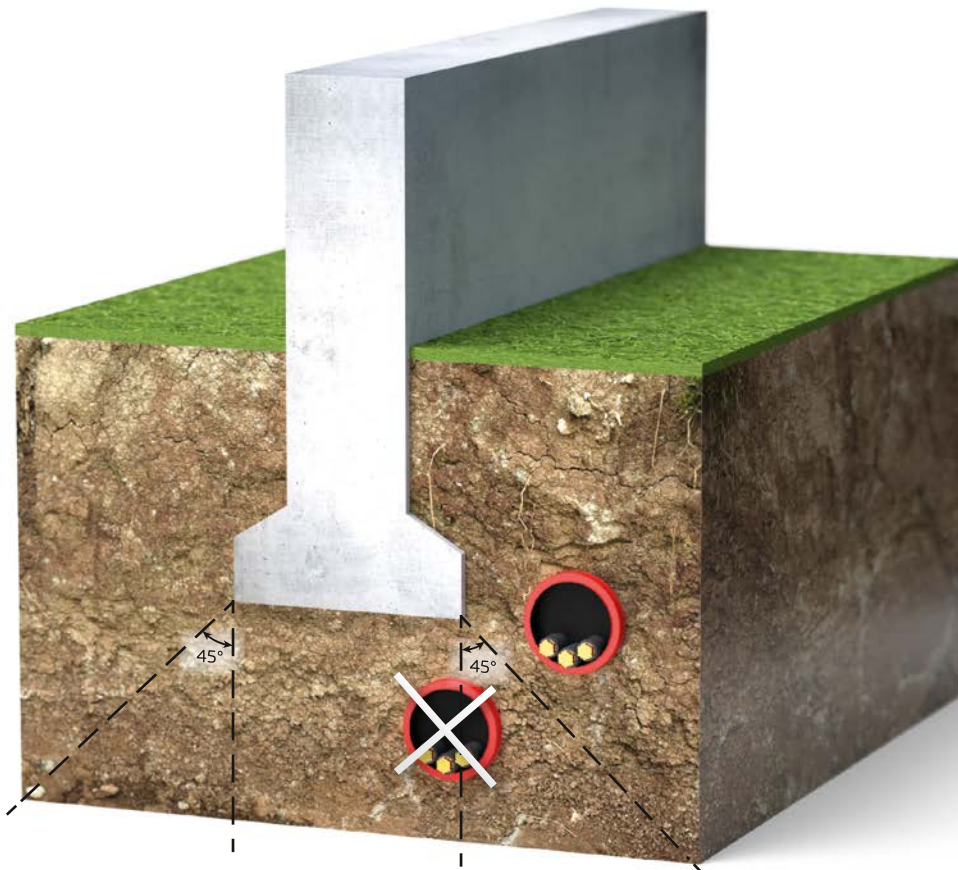
Рисунок №7. Прокладка труб вблизи фундаментов
